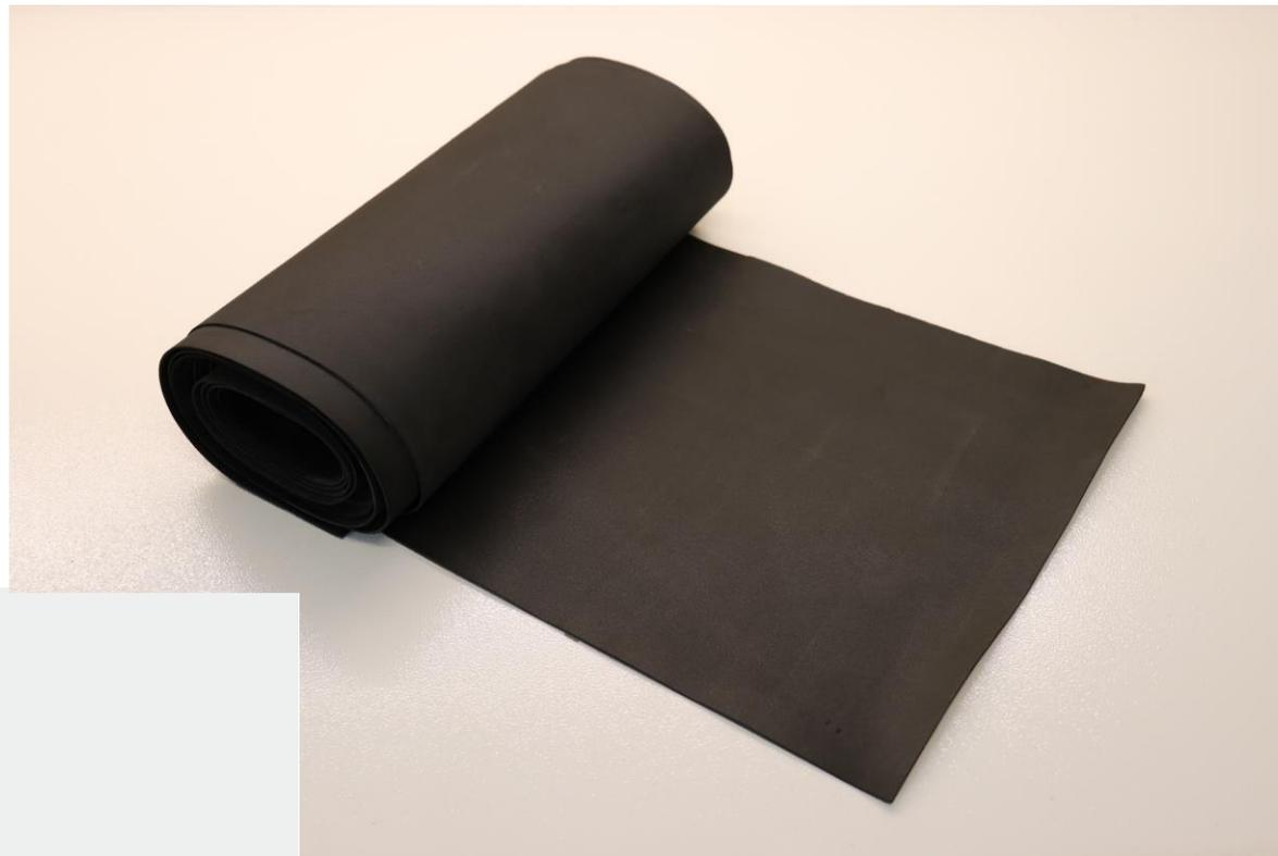
На основе герметика Абрис разработан радиопоглощающий материал с коэффициентом поглощения в диапазоне частот 2-4 ГГц 50-80%.
