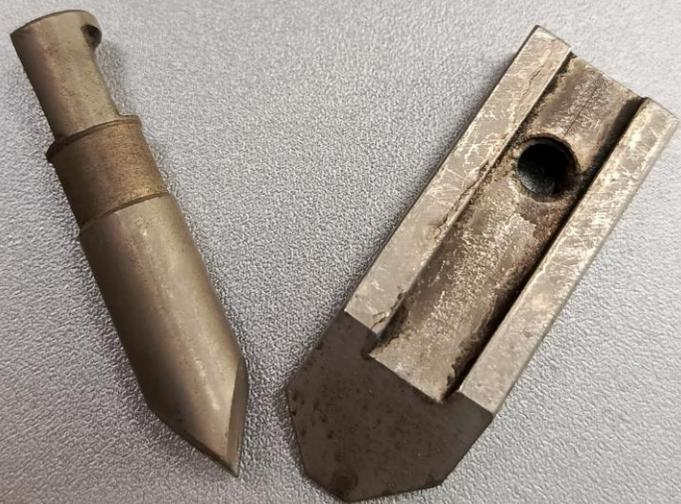
Обладают повышенной стойкостью, хорошо держат режущую кромку, допускают многократную переточку. По сравнению с натуральным алмазом имеют цену в 3-4 раза ниже при одинаковом ресурсе.
